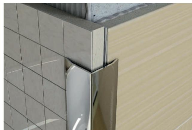
Угол защитный (наружный) предназначен для закрытия мест стыка различных покрытий на наружных углах и защиты их от истирания, деформации и разрушения в случае механического воздействия.
