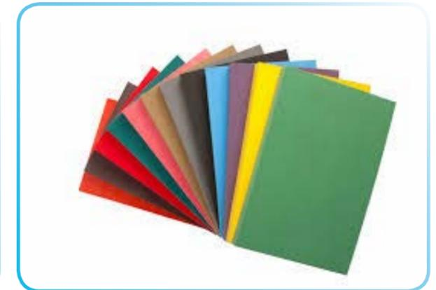
**Regufoam®** представляет собой полиуретановый эластомер со смешанной ячеистой структурой, выпускается с различной плотностью и твердостью (6 классов) или плотностью с комбинированной пружиной и демпфирующими свойствами. Различные плотности материала имеют цветовую маркировку. Числа в системе обозначений на эластомере **Regufoam** 150, 220, 300, 400, 510, 680 соответствуют плотности материала (кг/м<sup>3</sup>).
