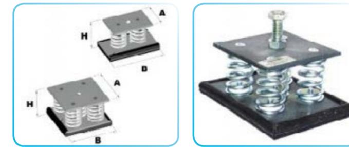
Виброизоляционные опоры из четырех стальных пружин и вставок из эластомера **Vibro-MS**. Специально разработанное оборудование, имеет низкую высоту (тип L) и очень эффективно при низкочастотных колебаниях. Специальное каучуковое основание действует как звукогаситель и повышает эффективность изоляции в области высоких частот, которые могут быть переданы через пружины. Пружины фиксируются с помощью инновационной системы крепления.
