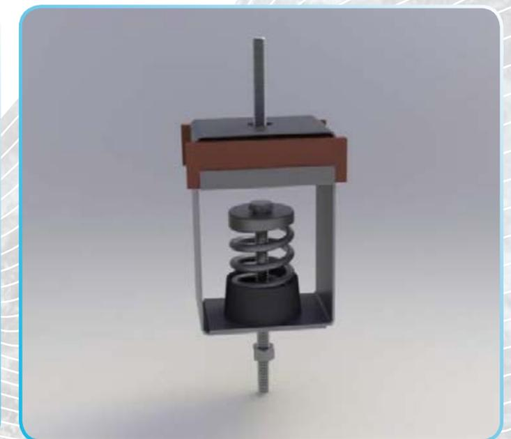
**Vibro-SHR** представляет собой комбинацию из специальной резины с металлической пружиной, служащую для лучшей виброизоляции низких и высоких частот, воспринимаемых человеческим ухом.
