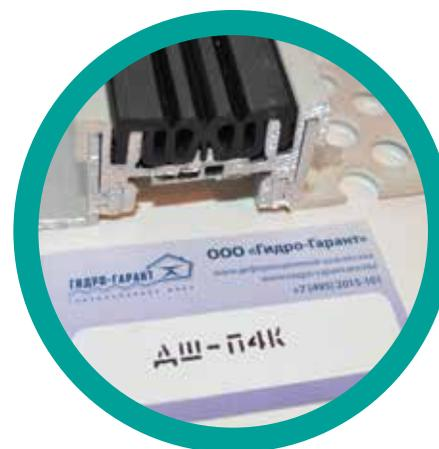
Для сборки конструкции необходимо иметь крепеж (подбирается монтажниками в зависимости от типа и прочности покрытия) из расчета крепления с шагом 250 мм-350 мм, т.е на 1 пог.м деформационного шва требуется около 6-8 штук крепежа. Рекомендуется использовать в качестве крепежа распорный анкер или дюбель-гвоздь. Для монтажа потребуются сверла по металлу и бетону под размер крепежа.
